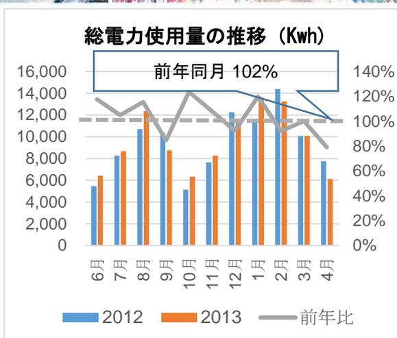
当初の予想通り、2013年は昨年の生産調整から増産・繁忙に向かい、空調機運転に対する内部負荷要素の労働時間は15%の増加となった。電気消費量は2%増加に止まり、実質10%の削減を達成した。夏季の冷房は昨年比で増加傾向でしたが、冬季の暖房運転時は減少し電力使用削減の効果が発揮されました。原因は空調機の老朽化と汚れによるCell Fresh ネットの節電効果の遅効性の表れだと思われまますので、2014年の冷房時は十分に効果を発揮すると思われまます。
